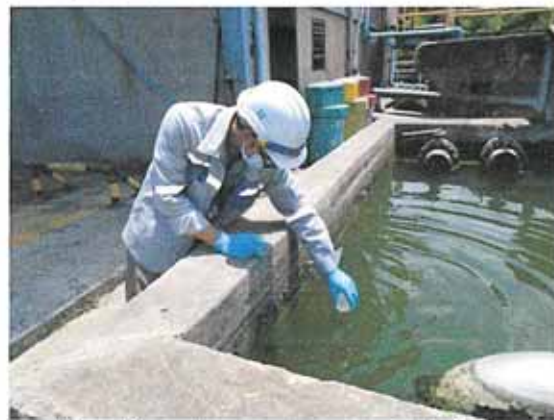
รูปที่ 10 น้ำจากบ่อ Effluent ของระบบบำบัดน้ำเสีย
